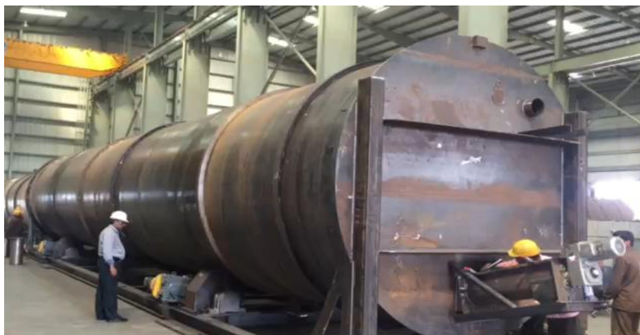
Тест за задвижване на Биореактор d=3m ; l=18m ;
